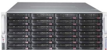
**Система хранения данных.** В роли СХД выступает одноконтроллерный сервер SM 6048R-E1CR36N с установленным ПО RAIDIX и конфигурацией FC 16Gb + JBOD 847E1C-R1K28JBOD. Система поддерживает SATA, SAS, NL-SAS диски.
