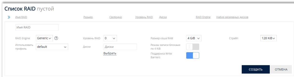
Рисунок 20. Виджет создания RAID. Система в DC-режиме
