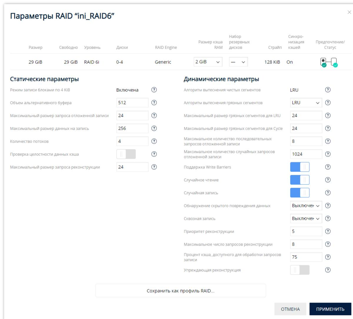
Рисунок 34. Дополнительные параметры Generic RAID в DC-системе
