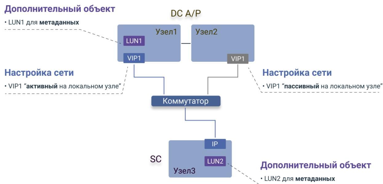
Рисунок 66. Схема СХД для репликации с DC Active/Passive на SC
