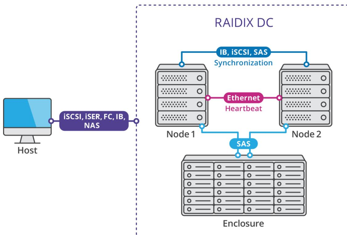
Рисунок 2. Схема двухконтроллерного режима работы системы RAIDIX 5.2.3
