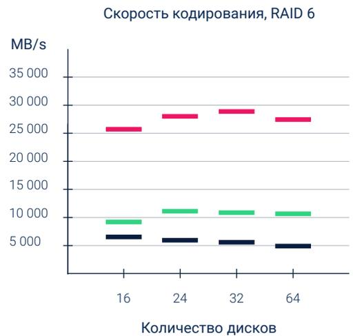
Высокая скорость расчета контрольных сумм (до 25 ГБ/с на 1 ядро) позволяет СХД на базе RAIDIX сохранять заданный уровень производительности при отказах накопителей и значительно снижать время восстановления системы.
