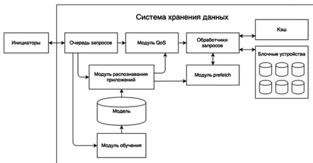
Рис. 1. Система хранения данных со встроенной технологией QoS<sub>mic</sub>
