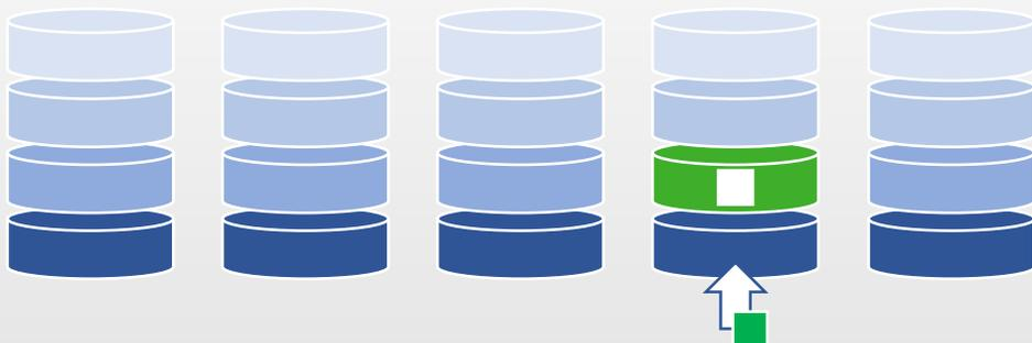
Частичная реконструкция эффективна для массивов больших объемов.
