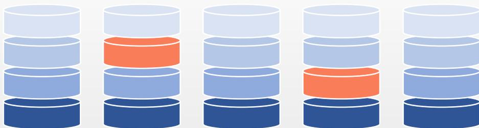
Сканирование и исправление скрытых ошибок выполняется RAIDIX в фоновом режиме в периоды низкой активности СХД.
